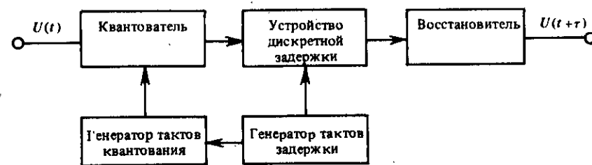
Рис. 2.2. Использование дискретной формы представления информации для создания высокостабильного аналогового устройства задержки.
